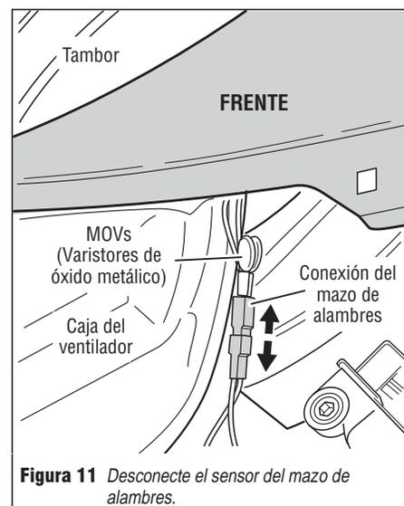
5. Logre acceso a los componentes electrónicos del control de la máquina. Vea Acceso y remoción de los ensamblajes electrónicos, en la página 7. Retire el conector P2 del tablero del control. Verifique las conexiones principales del mazo de alambres entre el mazo de alambres del sensor y el control de la máquina, para ver si hay un circuito abierto o un corto circuito.
